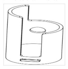
2. 本外观设计产品的名称: 试剂瓶适配器。 本外观设计产品的用途: 适应不同直径的试剂瓶,在试剂架中存放后有定位功能。 本外观设计产品的设计要点: 在于形状。 最能表明设计要点的图片或照片: 设计1立体图。 指定设计1为基本设计。
